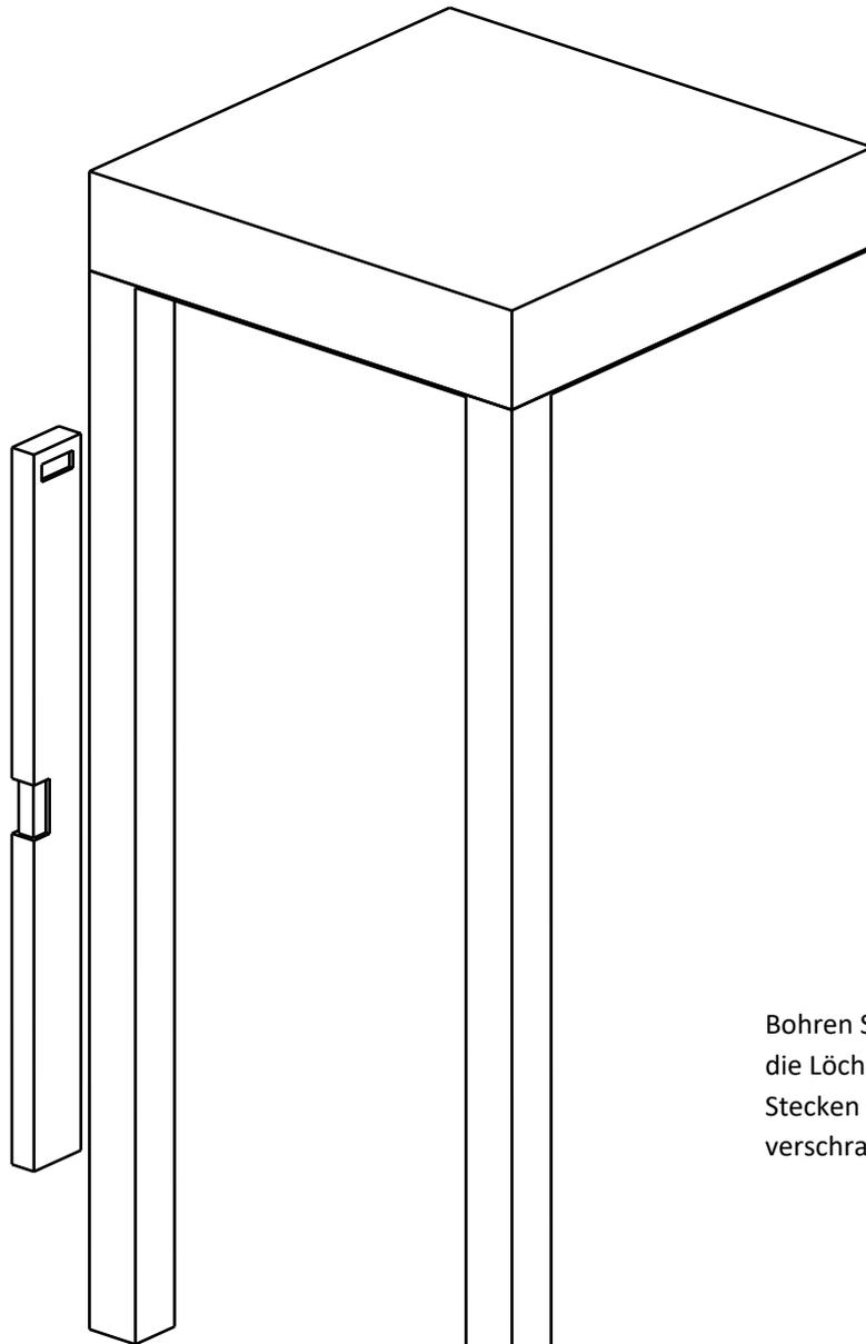
Bohren Sie mit einem 6mm Betonbohrer die Löcher für die Fußhalterungen.
