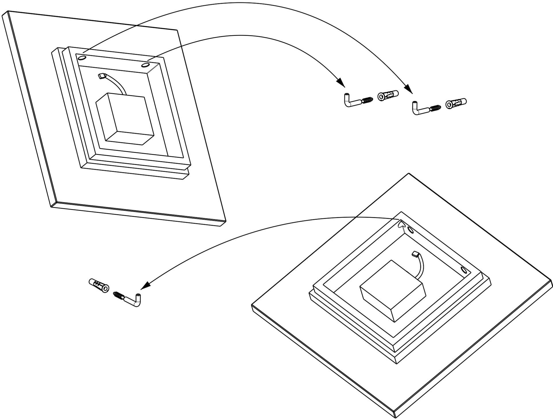
Um die Wandleuchte **horizontal** aufzuhängen, bohren Sie zwei Löcher im Abstand von 10 cm von Bohrloch zu Bohrloch mit einem Steinbohrer 8 mm. Nun stecken Sie beide Dübel M8 in die Bohrlöcher. Anschließend klopfen Sie die Dübel mit einem Hämmerchen in die Bohrlöcher. Drehen Sie nun die beiden Hacken so weit in die Wand, bis sie noch ca. 14mm herausstehen.
